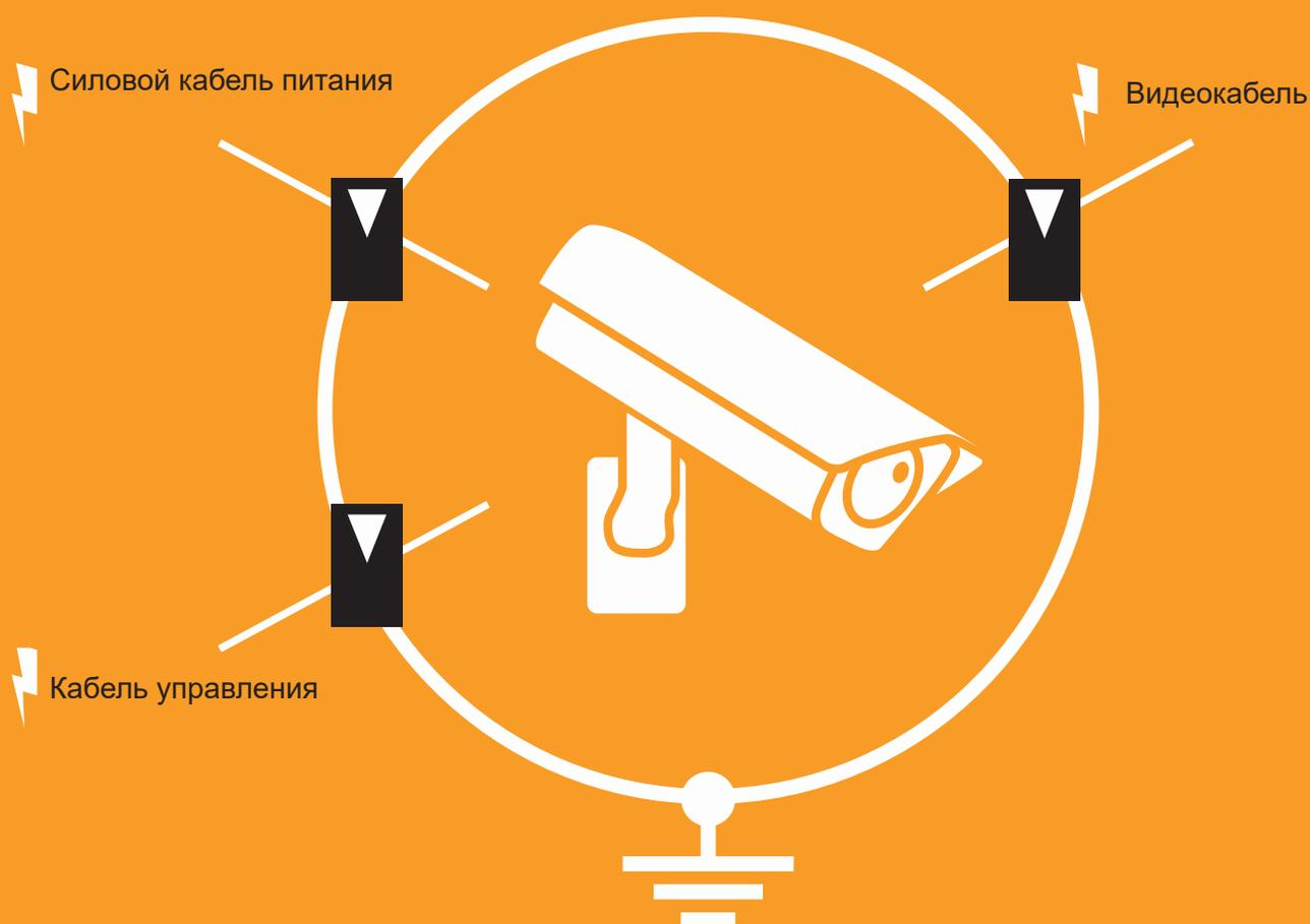
Для реализация всеобъемлющей концепции защиты от импульсных перенапряжений все части терминала или любого оборудования, способные переносить ток, должны быть включены в систему уравнивания потенциалов. В случае систем видеонаблюдения это различные интерфейсы, которыми оснащена видеокамера. В зависимости от версии, число варьируется от одного до трех.
